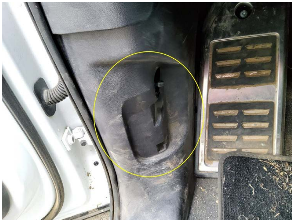
Bild 10 : Griff Motorhaubenbetätigung gebrochen
