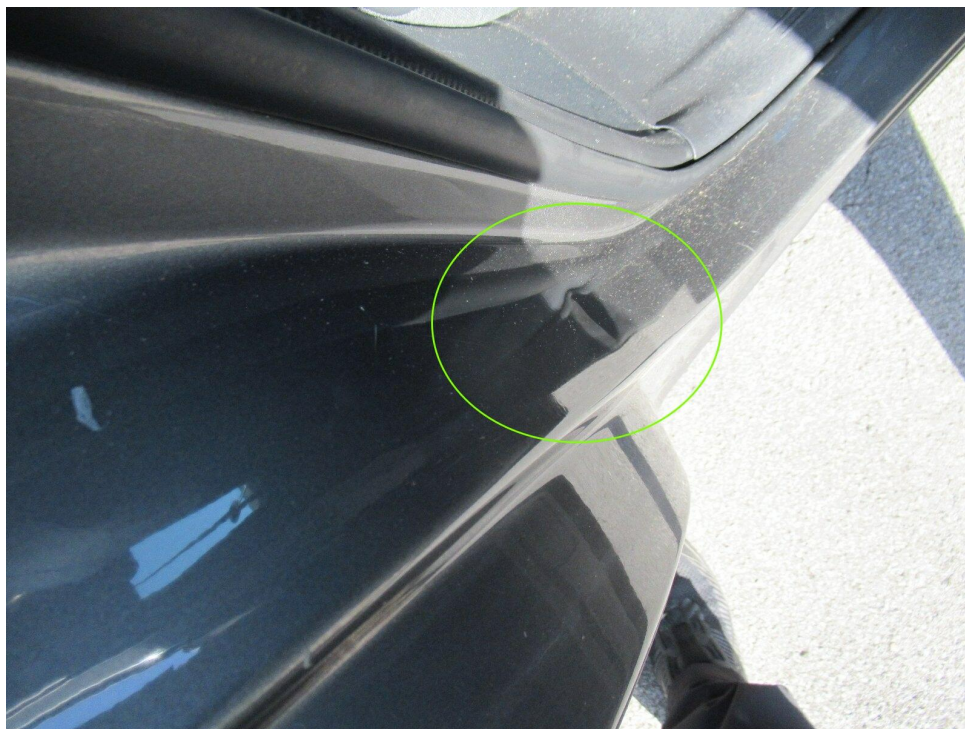
Bild 7 : Tür hinten rechts Einstieg, eingedellt, instandsetzen und lackieren mit Lackaufbau
