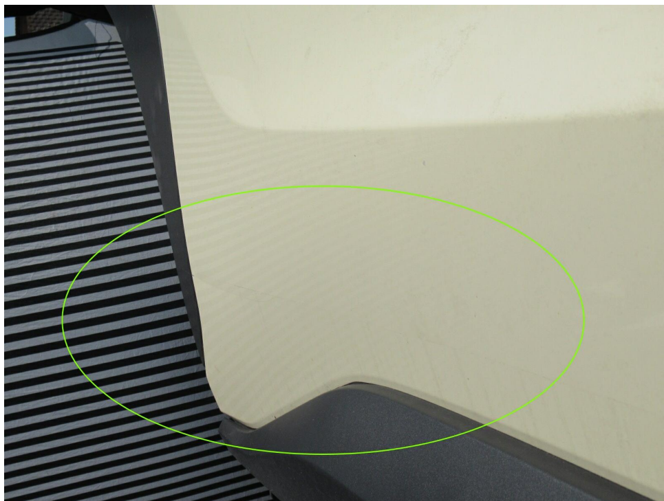
Bild 21 : Tür hinten rechts, deformiert, instandsetzen und lackieren mit Lackaufbau Tür hinten rechts, Folierung anbringen
