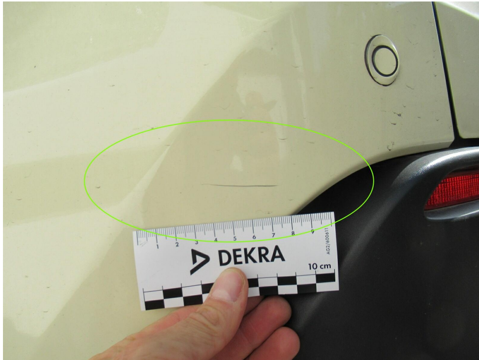
Bild 19 : Stoßfänger hinten Lackierung, zerkratzt, smart repair Stoßfänger hinten, Folierung anbringen
