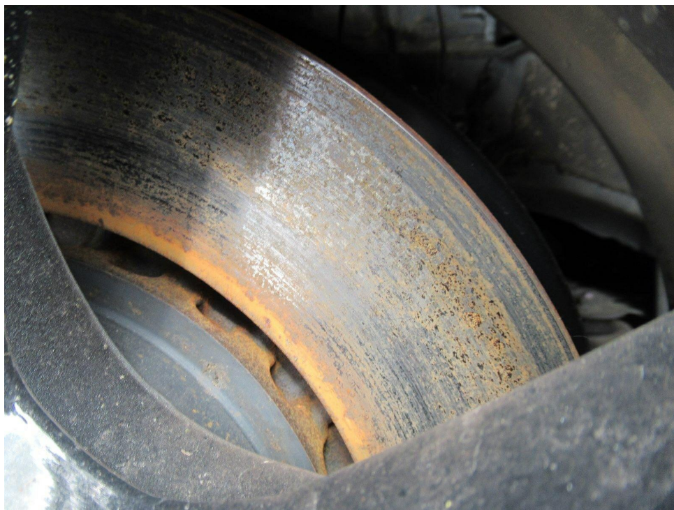
Bild 14 : Bremsscheiben vorne und hinten, Standschaden, Freibremsen und
