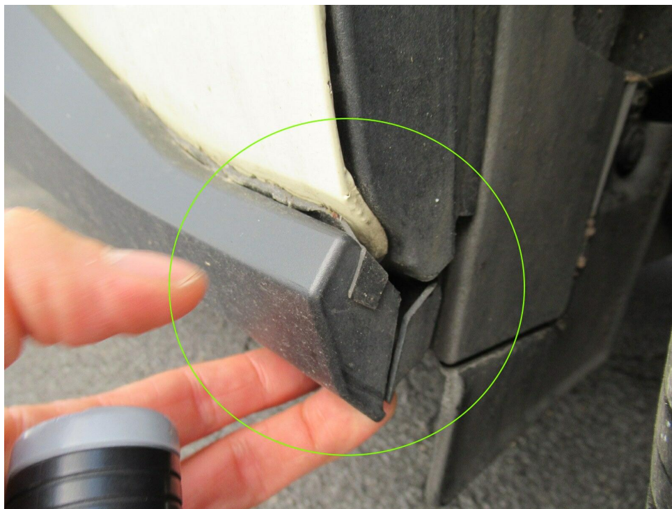
Bild 18 : Tür hinten links, Restdeformationsspuren ersichtlich Zierleiste beschädigt und lose
