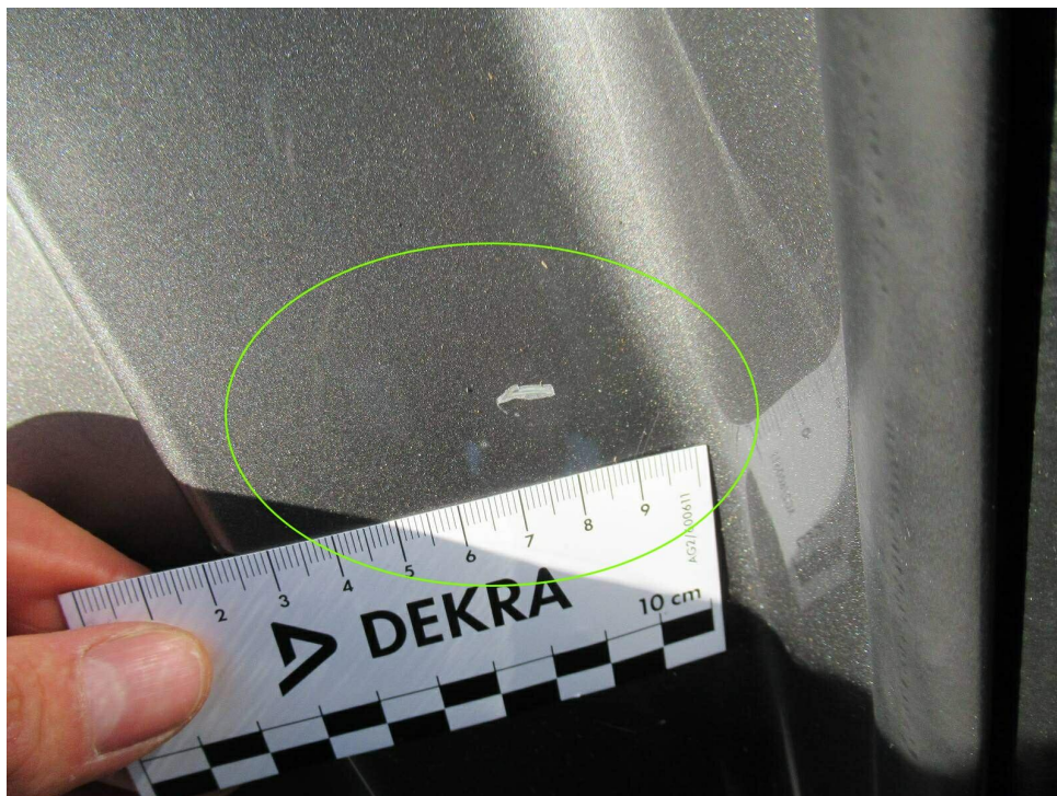
Bild 6 : Tür hinten rechts Einstieg, eingedellt, instandsetzen und lackieren mit Lackaufbau
